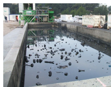
Eau surnageante sur sédiments bruts dans le bassin d'accueil
